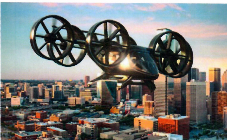
Der Bell Nexus wird hybrid-elektrisch angetrieben und bietet Platz für vier Passagiere und einen Piloten. Später soll auch eine Version ohne Pilot folgen.
